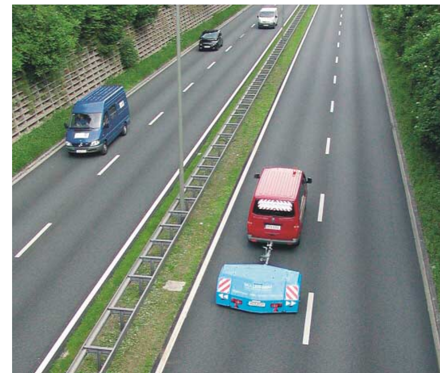
Abb. 11: Für Nahfeldmessungen wird meist ein geräuschedämmter Anhänger verwendet
