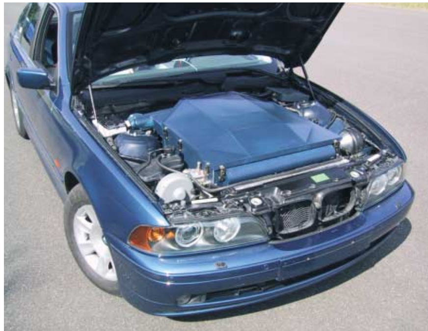
Abb. 13: In »Watte« gepackt: der Motor des Spezialfahrzeuges des TÜV SÜD
