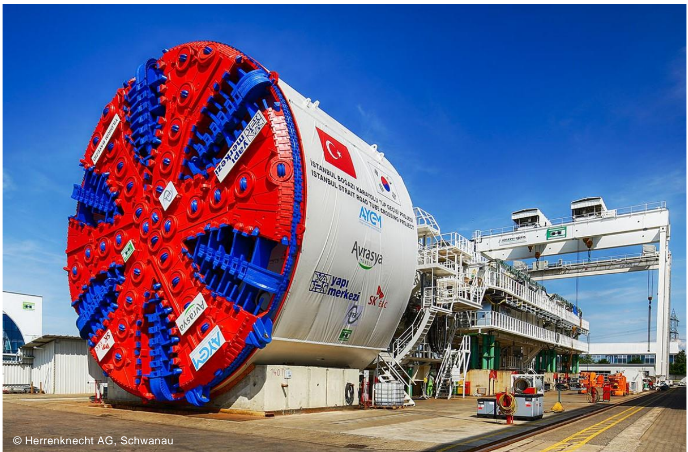
Mixschild-Maschine Istanbul (Türkei), Aussendurchmesser 13.70 m
